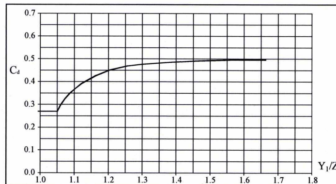
Figura 23: Diagramma per la stima del coefficiente di deflusso C_d
