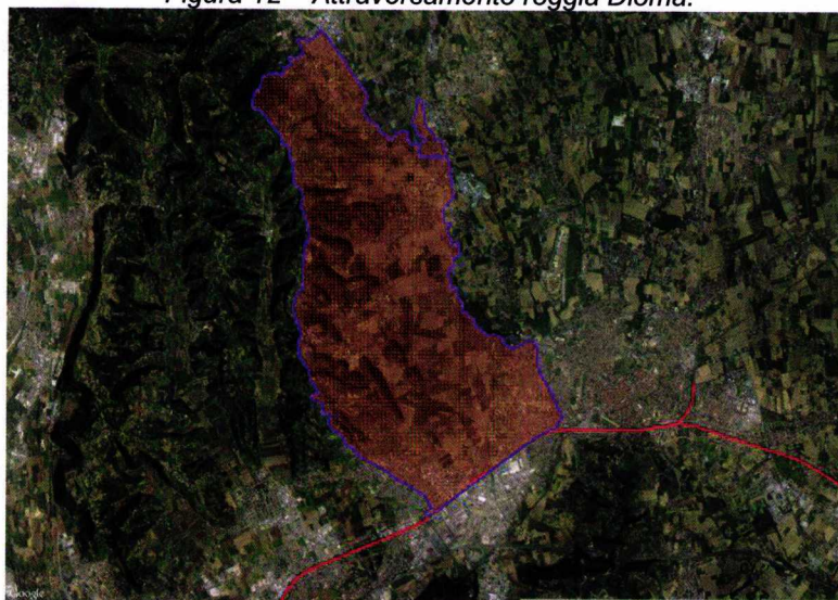
Figura 13 – Bacino roggia Dioma alla sezione di chiusura determinata dalla nuova linea AV/AC .
