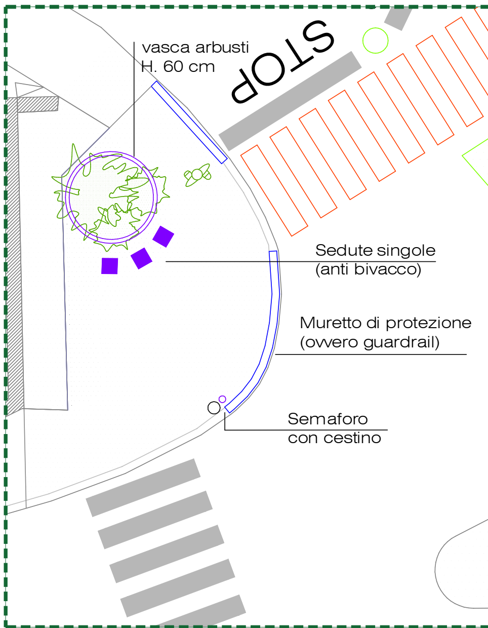
Particolare - scala 1:250 Nuova area di sosta pedoni
