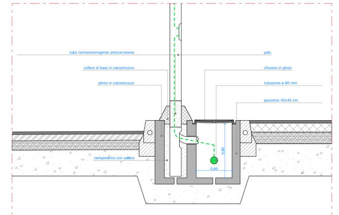
SEZIONE SUL PALO E SUL POZZETTO - scala 1:20
