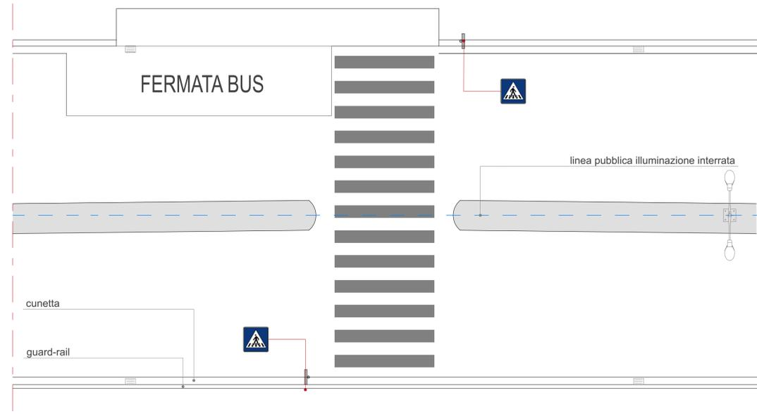
SCHEMA TIPO CON LINEA P.I. INTERRATA - RILIEVO - scala 1:100
