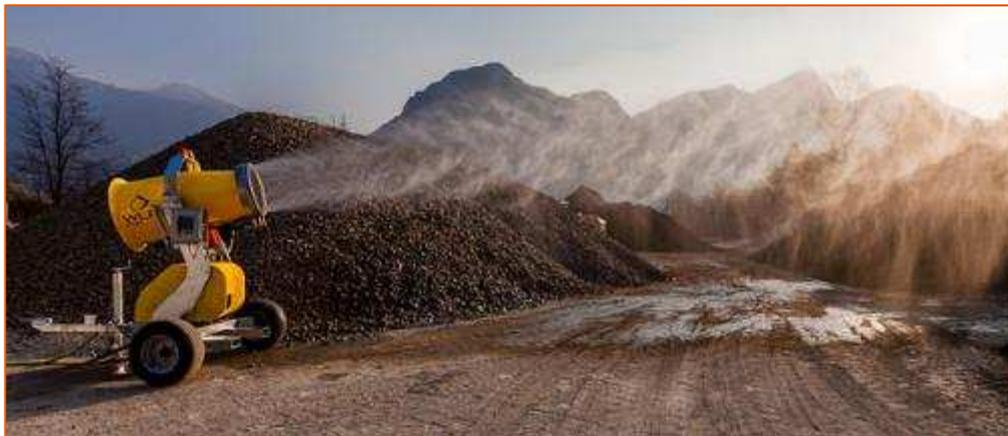
Figura 24: Cannone nebulizzatore in azione
