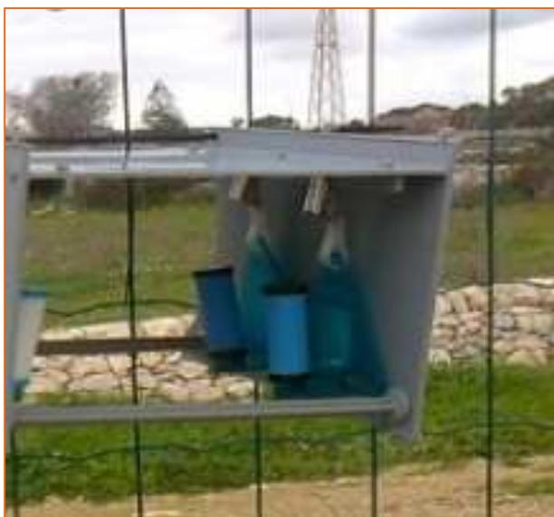
Figura 84: AQ3, esempio di postazione di misura con radielli
