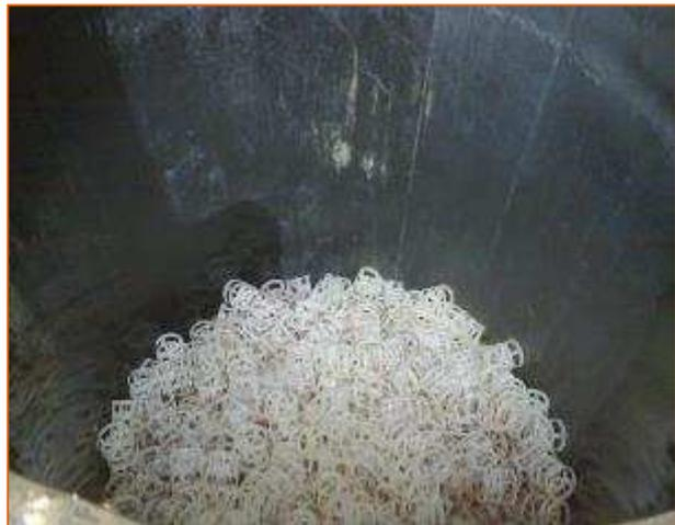
Figura 10: Particolari interni dei filling rings di una torre di strippaggio simile a quella installata. Nella foto di destra si evidenziano i corpi di riempimento appena sostituiti.
