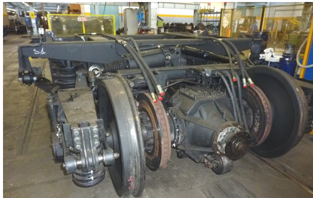
Carrello ETR470 in manutenzione
