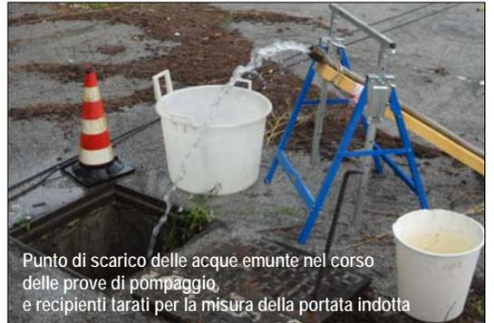
Punto di scarico delle acque emunte nel corso delle prove di pompaggio, e recipienti tarati per la misura della portata indotta
