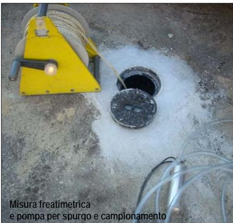
Misura freaticometrica e pompa per spurgo e campionamento
