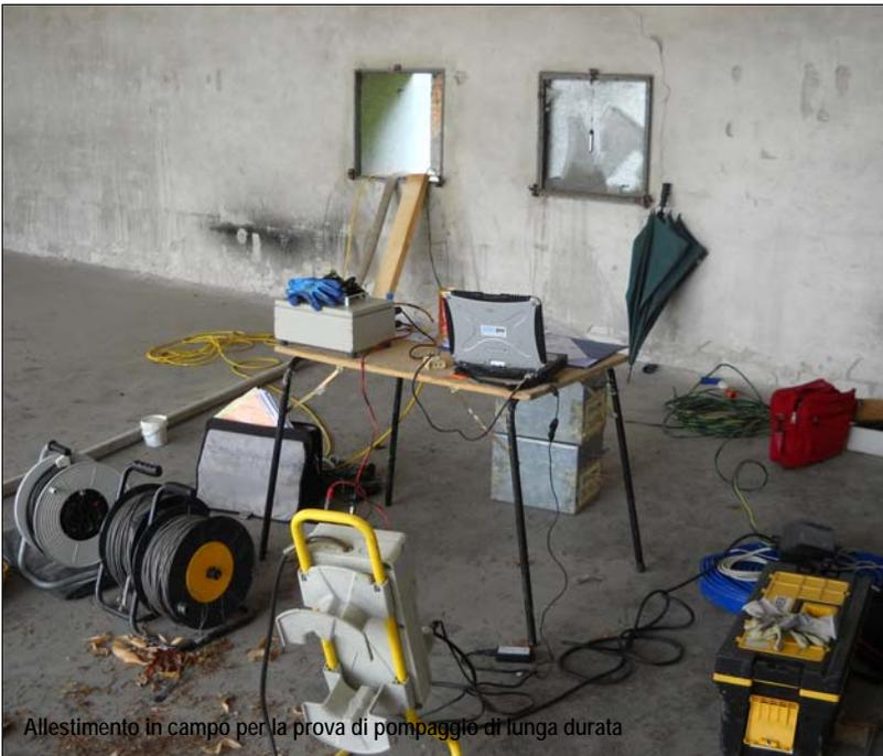
Allestimento in campo per la prova di pompaggio di lunga durata
