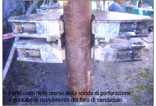
Particolare delle morse della sonda di perforazione e del tubo di rivestimento del foro di sondaggio
