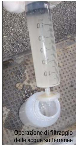
Operazione di filtraggio delle acque sotterranee
